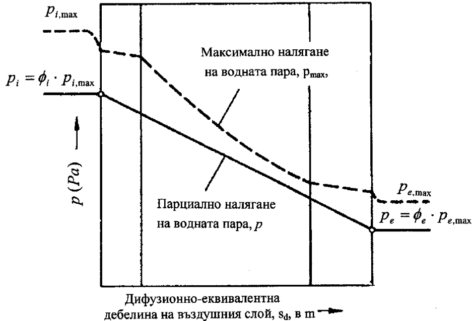
Фиг. 6.2. Схема на максималното и парциалното налягане през многослойна ограждаща конструкция или елемент, съответстващи на температурата, за изчисляване на евентуален кондензационен пад
